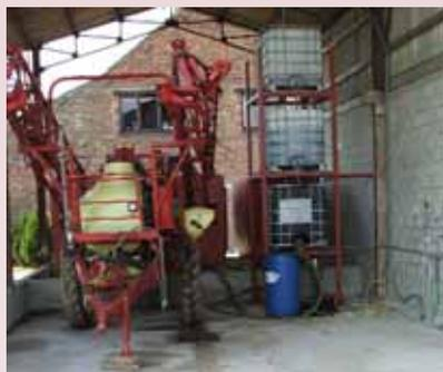
sur une zone enherbée ou *via* l'utilisation d'un système spécifique : aire de remplissage équipée d'un biofiltre permettant de traiter les eaux chargées en produits phytopharmaceutiques à la ferme (photo i).
